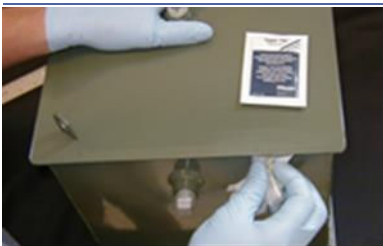
Pase un paño limpio en el área antes de aplicar el sellador
