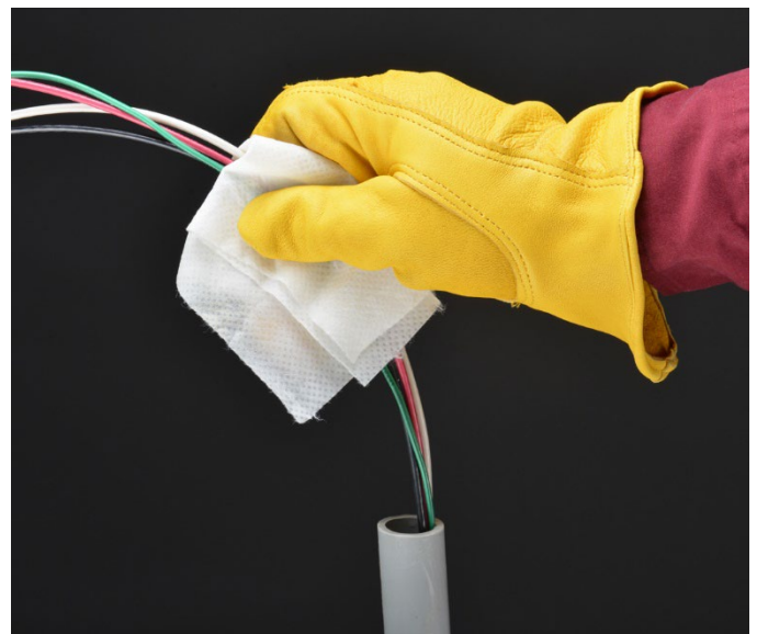
Aplicación esparcida con Polywater SPY-D20
