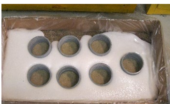
PedFloor scorre e si espande dopo 20 minuti
