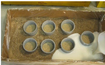
PedFloor se mezcla y se vierte
