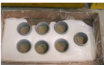
PedFloor fluye y se expande después de 20 minutos
