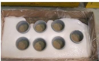
InstaGrout scorre e si espande dopo 20 minuti
