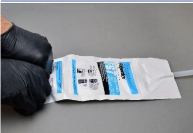
Éclater le joint central.
