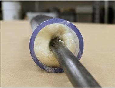
8. ZipSeal dehnt sich in etwa 1 Minute vollständig aus und härtet in 2 Minuten aus. Überprüfen Sie die Abdichtung auf offensichtliche Lücken. Diese können mit zusätzlichem ZipSeal gefüllt werden.
