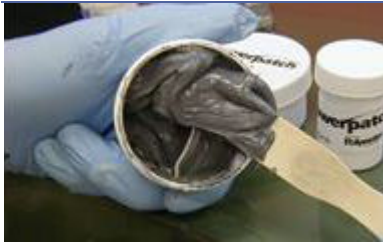
Die 2-Komponenten-Dichtungspaste zu einer gleichmäßigen grauen Farbe mischen
