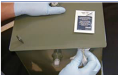
Reinigen Sie den Bereich mit einem Reinigungstuch, bevor Sie das Dichtungsmittel auftragen.
