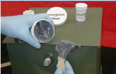
PowerPatch über Spachtelmasse-Patch oder der Leckstelle auftragen
