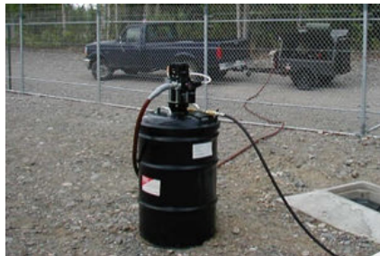
IceFree Fass mit angeschlossener Schmierpumpe.
